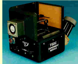
FSDC: Fiber-Supported Droplet Combustion kísérleti berendezés
